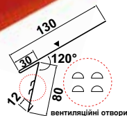
Вентиляційна карнизна планка з додатковою перфорацією, P=250
