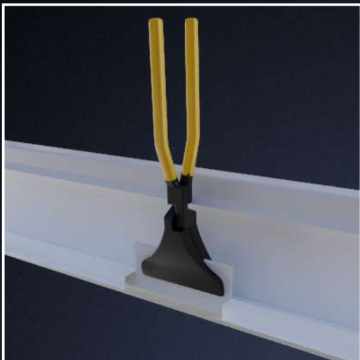
Підгинаємо вирізану частину накладки ринви.
