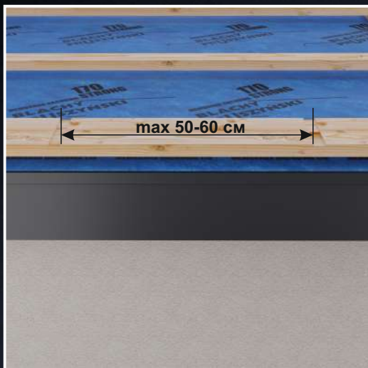
Гаки, що залишилися, кріпимо на відстані макс. 50-60 см один від одного.
