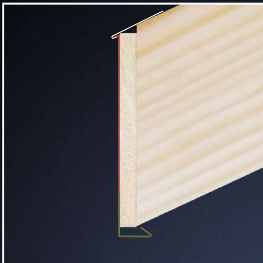
Поперечний переріз після монтажу нижнього зв'язу.
