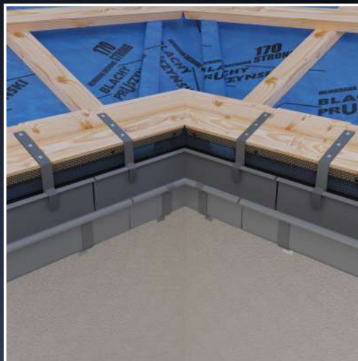
Ринви і кути монтують на гаки із зазором 5-10 мм (для термічного розширення).
