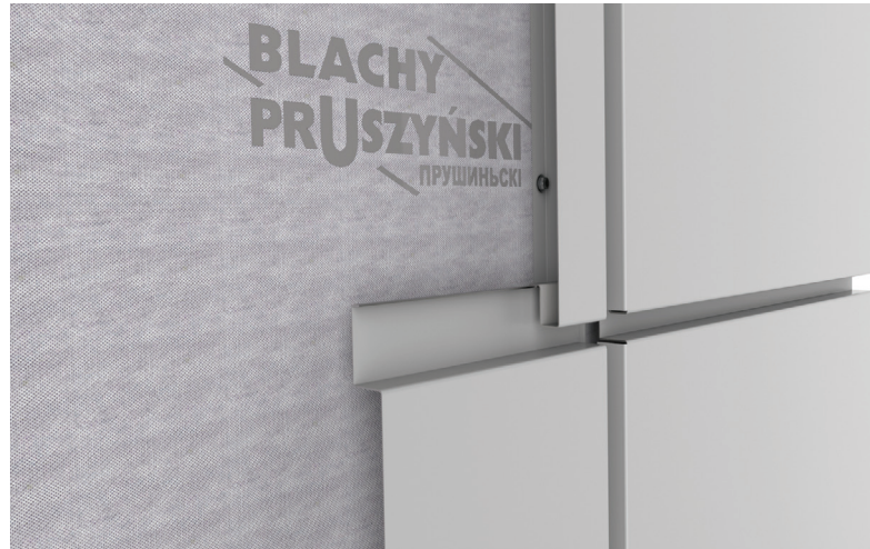
Рис. 6.2. Вертикальне з'єднання касетонів з закритим стиком
