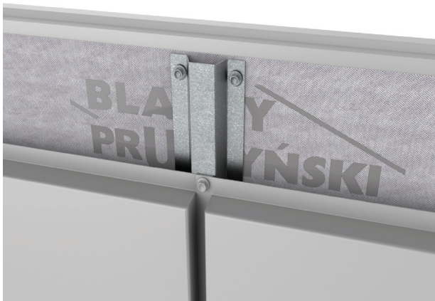
Рис. 10.1. Вертикальне з'єднання касетонів з відкритим стиком
