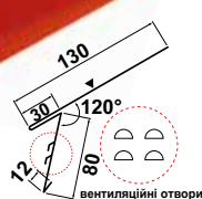
Вентиляційна карнизна планка з додатковою перфорацією, P=250
