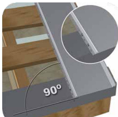
Рис. 11. Панелі повинні бути укладені перпендикулярно до карнизу. Панель кріпиться до карнизу за допомогою двох саморізів
