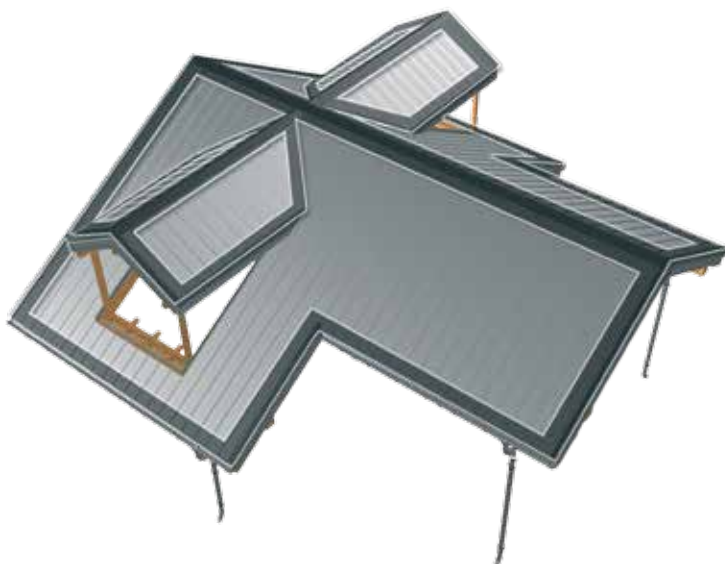
Рис. 8. Кутові ділянки, які особливо піддаються впливу вітру
