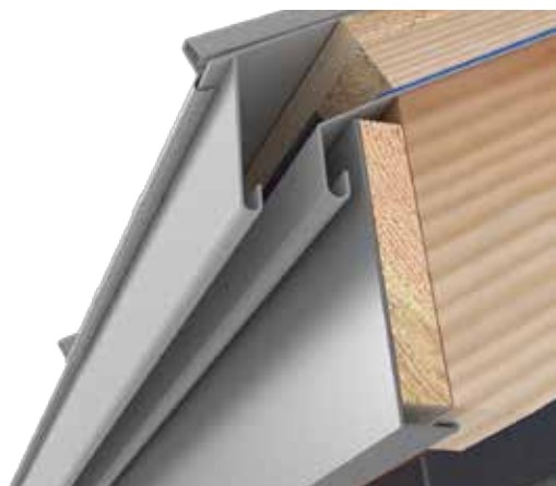
Рис. 10. Панель висувається над карнизом на 4-5 см
