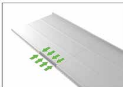
Рис. 24. Після стикування панелей затиснути місце з'єднання
