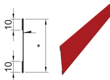
\* Стартову планку для касетону K-2 рекомендуємо виготовляти із металу мінімальною товщиною 0,75 мм
