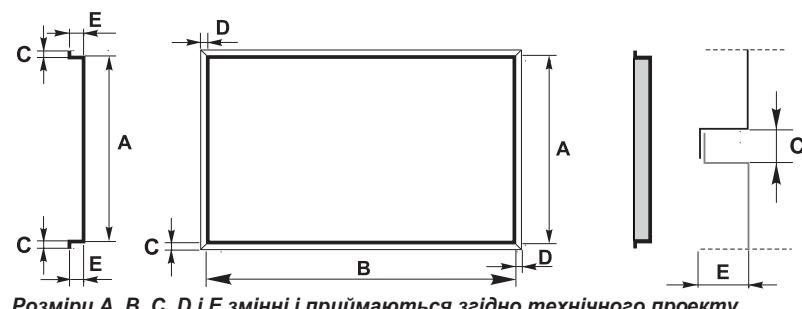
Рис. 10. З'єднання касетонів з відкритим стиком
