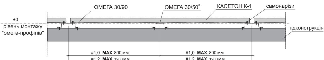
\* Касетон не слід кріпiti жорстко до додаткового  $\Omega$ -профілю, щоб при температурному розширенні дати можливість його дзеркалу працювати рівномірно
