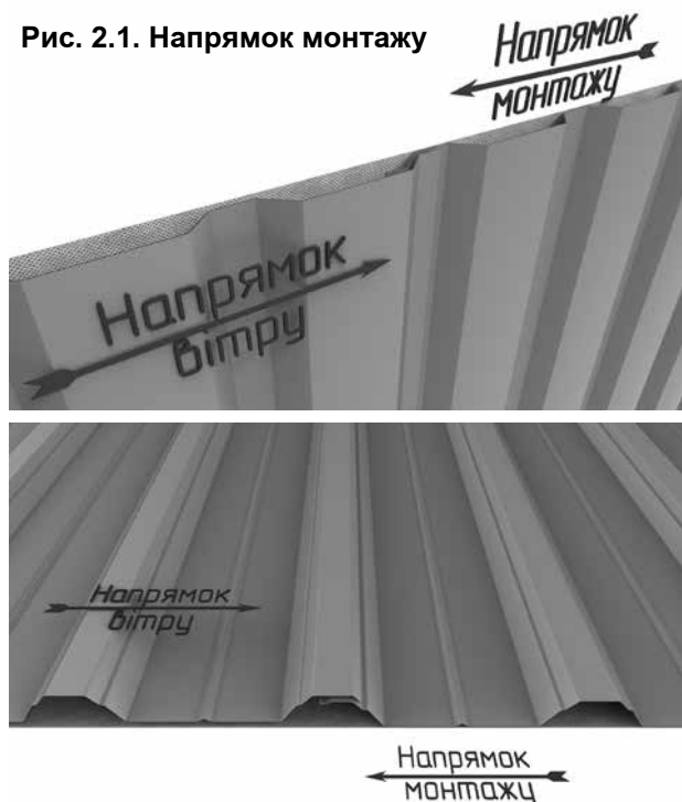
Рис. 2.2. Черговість монтажу металопрофілю
