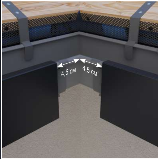
Накладки монтуємо на відстані 4,5 см від кута.
