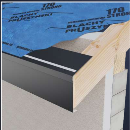
Монтаж покрівельної мембрани на обрешітці. Приклеювання мембрани до верхнього звісу.
