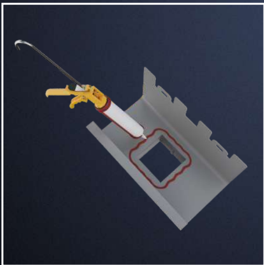
Наносимо клей для герметизації з'єднання краю ринви з лійкою.
