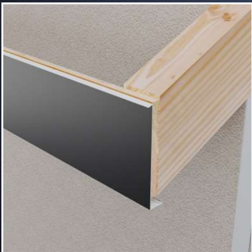
Монтаж нижнього зв'язу до startової планки. Нижній згин дає можливість змонтувати підшиву (софїти) до цієї планки (див. стор. 22).
