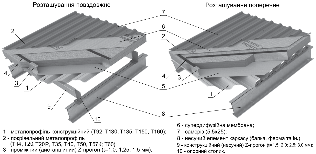
Рис. 6. Застосування конструкційного металопрофілю
