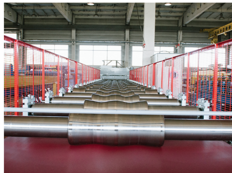
Лінія з виробництва металочерепиці АРАД на українському заводі працює з 2016 року і випускає два види продукції – АРАД Класік і АРАД Оптіма
