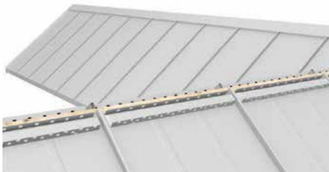
Рис. 31. Коньок монтується на вентиляційній підконьковій планці
