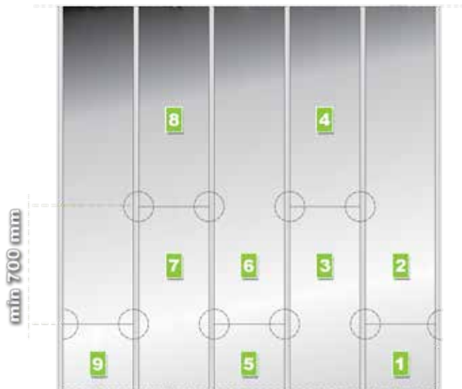
Рис. 19. Послідовність монтажу панелей - пунктирними кружками позначені місця, де вирізані замки
