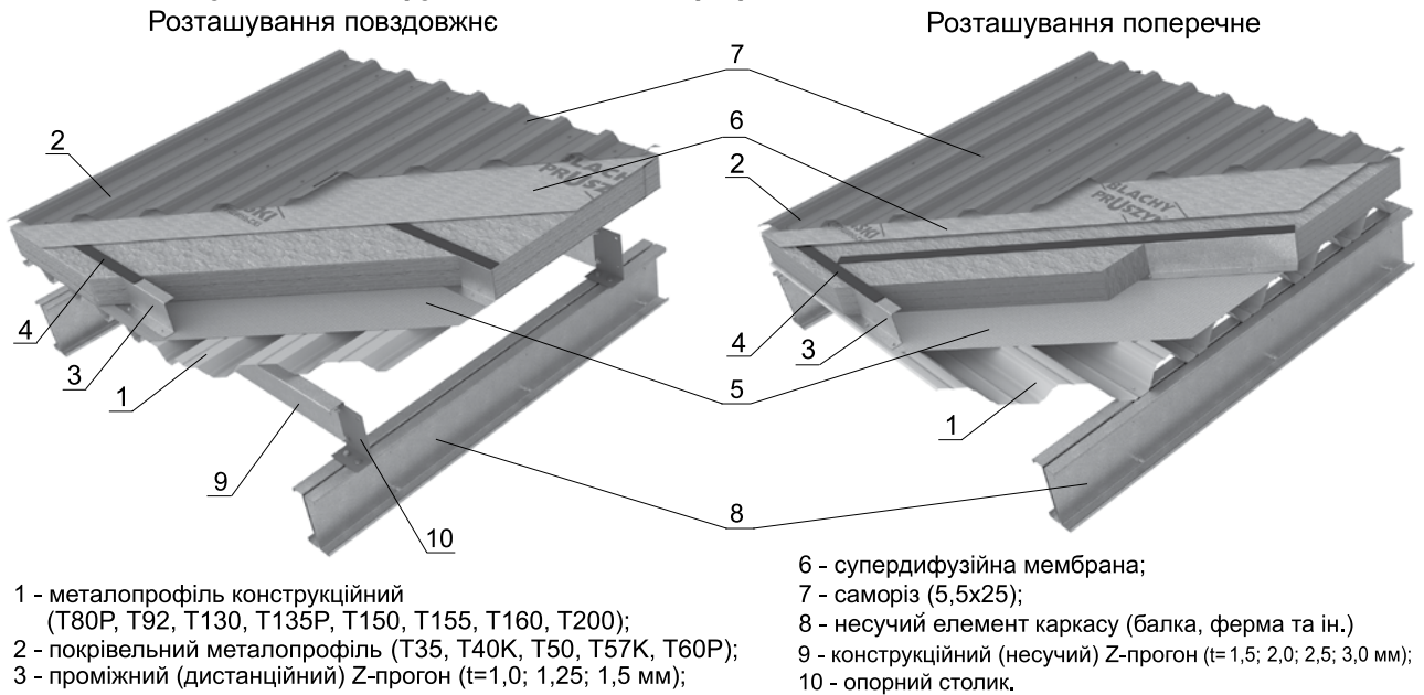
Рис. 6. Застосування конструкційного металопрофілю
