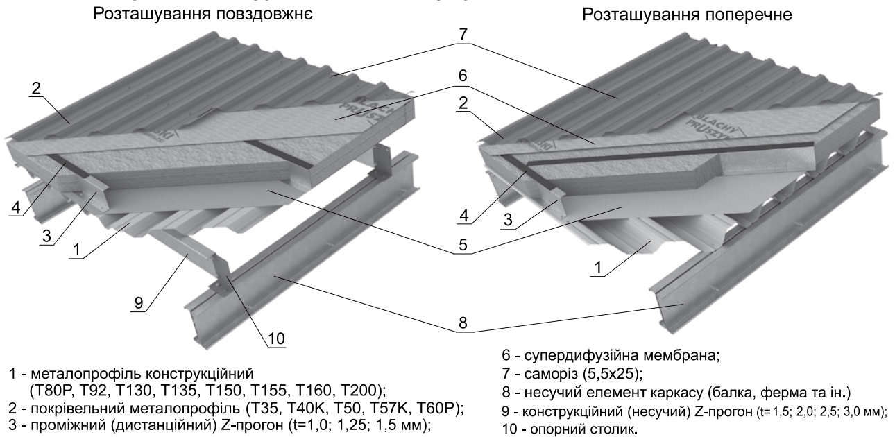
Рис. 6. Застосування конструкційного металопрофілю
